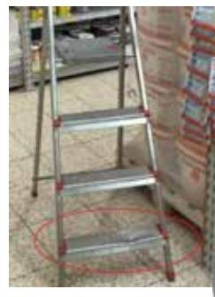
Beschädigte/gebrochene Stufen an der Leiter, die eine unsichere Benutzung verursachen
