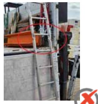
È necessario sostituire la scala con il longherone danneggiato
