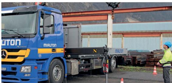
7. Verwenden Sie einen Kran zum Be- und Entladen von Materialien und bedienen Sie den Kran vom Boden aus in einem sicheren Abstand.
