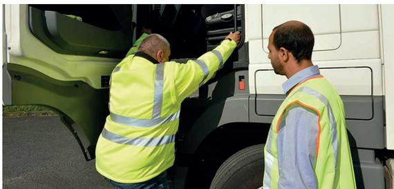
1. Verwenden Sie beim Ein- und Aussteigen aus der Kabine und beim Benutzen einer Leiter 3 Kontaktpunkte. In diesem Fall benutzt der Fahrer seine beiden Hände und einen Fuß.
