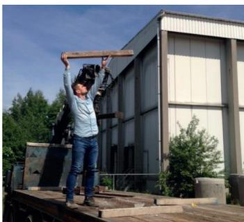
Der Lkw-Fahrer stieg auf die Ladefläche des Lkw, um manuelle Arbeiten durchzuführen. Er rutschte jedoch auf der Kante der Plattform aus, da sich das Fett des Mobilkrans angesammelt hatte. Infolgedessen erlitt er durch den Sturz eine Unterschenkelverletzung. (Fotorekonstruktion)
