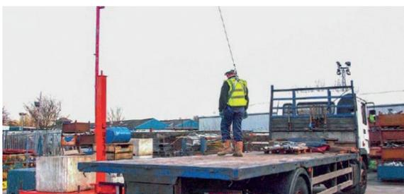
3. Verwenden Sie bei der Reinigung der (Ladefläche des) Stapler(s) eine Absturzsicherung oder benutzen Sie geeignete Geräte, um vom Boden aus zu reinigen.
