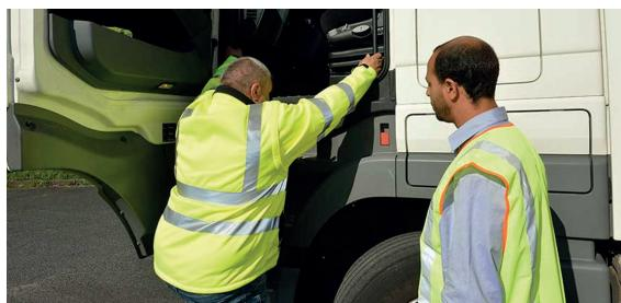
1. Utiliser 3 points de contact pour monter et descendre de la cabine et pour utiliser une échelle. Dans ce cas, le conducteur utilise ses deux mains et un pied.
