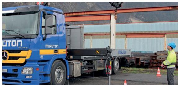
7. Utiliser une grue pour charger et décharger des matériaux et manœuvrer la grue depuis le sol à une distance sûre.
