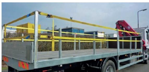
3. Quando si pulisce il (pianale di carico del) carrello, usare una protezione antcaduta o utilizzare l'attrezzatura appropriata per pulire da terra.
