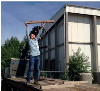
L'autista del camion è salito sul retro dell'autocarro per eseguire un lavoro manuale. Tuttavia, è scivolato sul bordo della piattaforma a causa del grasso assemblato dalla gru mobile. Di conseguenza, ha riportato una lesione alla parte inferiore della gamba a causa della caduta. (ricostruzione fotografica)
