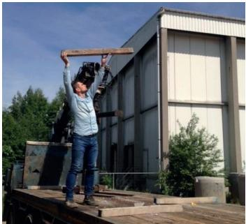
O camionista pisou na parte de trás do camião para realizar trabalhos manuais. Contudo, escorregou na borda da plataforma devido à massa lubrificante montada da grua móvel. Como resultado, sofreu um ferimento na perna inferior devido à queda.
