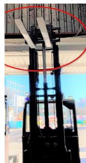
Um operador de empilhador foi projetado do veículo enquanto conduzia em alta velocidade com um mastro elevado, quando bateu no portão.
