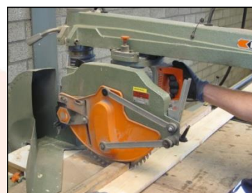
Leg het werkstuk op de machine en druk het tegen de aanslag. Verplaats de unit door de handgreep naar je toe te trekken.
