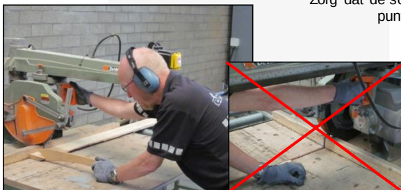
Houd de hand die het werkstuk aandrukt op voldoende veilige afstand van de zaaglijn. Gebruik indien nodig een duwhout.
