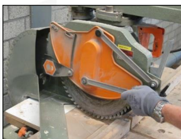
Controleer of het zaagblad goed is gemonteerd en vrij draait. Zorg dat de schalmen altijd op het laagste punt staan.
