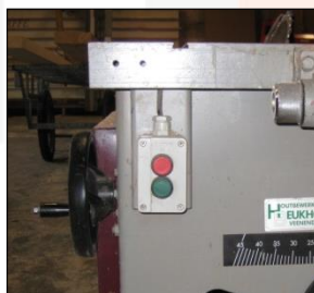
De rode knop schakelt de machine in één keer uit.
