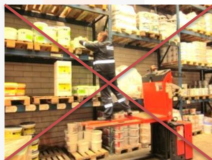
Voor werken op hoogte gebruik je een ladder, of je haalt de pallet naar beneden.
