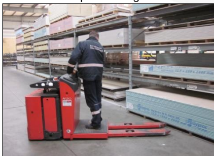
Duw de lading niet in de schappen, maar gebruik altijd beide vorktanden om een pallet goed te plaatsen.
