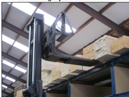
Schuif de houtklem rustig onder het pakket hout.
