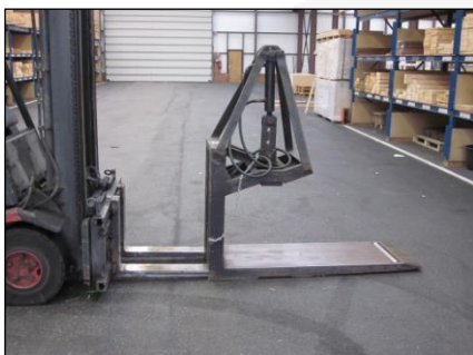
Schuif de lepels van de heftruck zo ver mogelijk in de houtklem.
