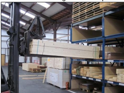
Plaats het hout op de nieuwe hoogte in de stelling en schuif het pakket rustig verder het schap in of zet het pakket klaar voor verder vervoer.
