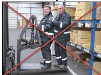
De houtklem is voor hout! Verplaats of til nooit personen met een houtklem.
