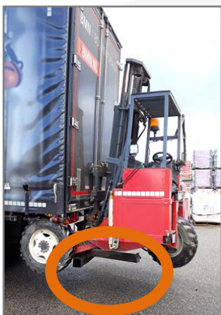
Zorg er voor dat de beveiligingsbalk onder de heftruck is vastgezet.
