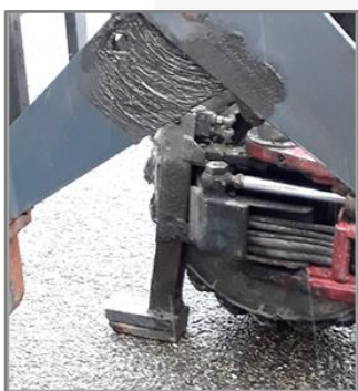
Gebruik bij het heffen van zwaardere lasten altijd de hydraulische steunpoten. Breng de last boven de wielpoten alvorens te gaan rijden.
