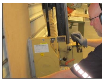
Zet de 'drukschoen' tegen het te zagen materiaal zodat dit goed tegen de achterwand wordt gedrukt.
