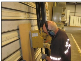
Plaats bij verticaal zagen de zaagbalk op de goede plaats, blokkeer de zaagunit, schakel de motor in en beweeg de zaagunit rustig van boven naar beneden. Zet de zaagunit na beëindiging van de werkzaamheden altijd terug in de ruststand.
