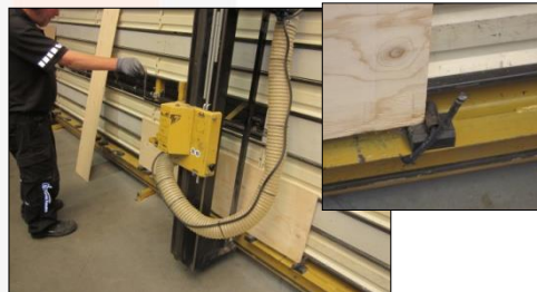
Plaats bij horizontaal zagen de zaagbalk aan de linkerkant van de plaat, blokkeer de zaagunit, schakel de motor in en beweeg de zaagunit rustig van links naar rechts. Zorg er voor dat het materiaal niet weg kan schieten.
