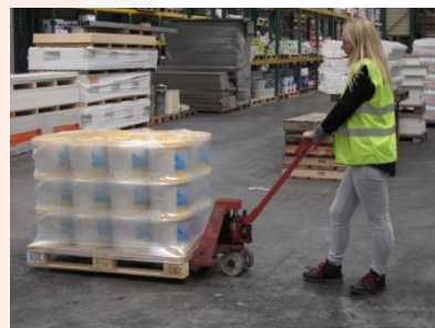
De lading moet stabiel zijn.
