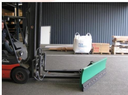
Breng de lepels met de sneeuwschuiver op de juiste hoogte. Laat de mast iets naar voren neigen.
